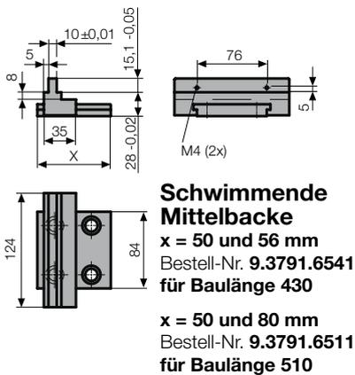
**Standard-Spannbacken weich zum Einfräsen von Werkstückkonturen, Stufen, Anschlägen etc. Lieferung einschließlich Befestigungsschrauben**
