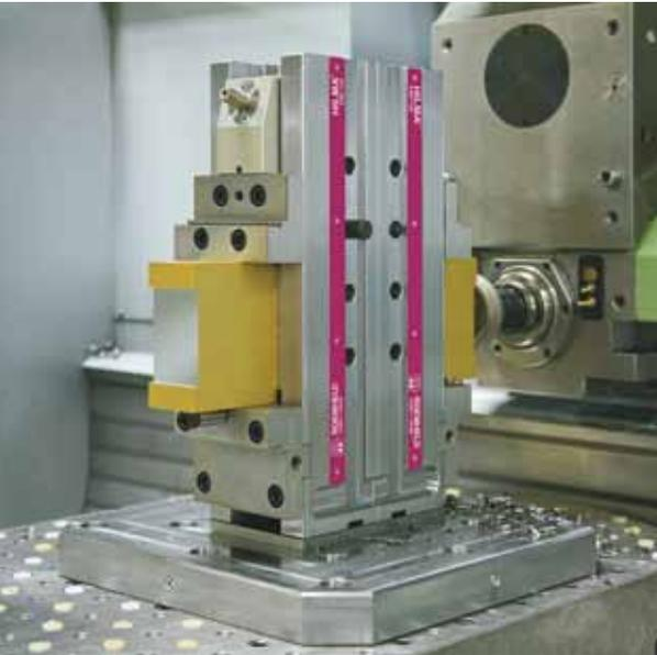
NC mit Spannkraftanzeige
