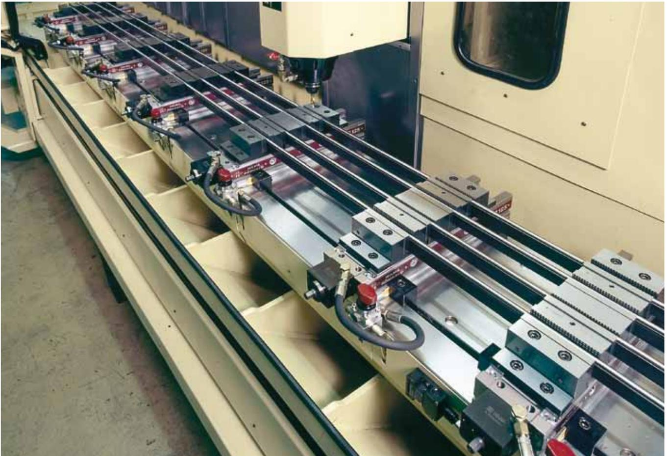
DS hydraulisch betätigt, Einsatz in Reihenanordnung zum Spannen von Werkstücken, die mehrere Spannstellen erfordern. Automatisierbar.
