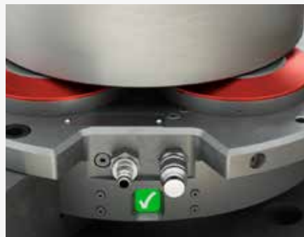
Die grüne Anzeige zeigt, dass richtig gespannt ist.
