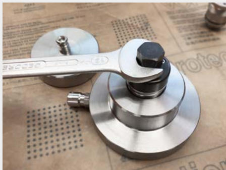
Festschrauben mit Montageschlüssel (15 Nm)
