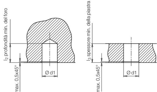
Ø di regolazione della bussola di bloccaggio:  $k = d1 - 0,2 \text{ mm}$
