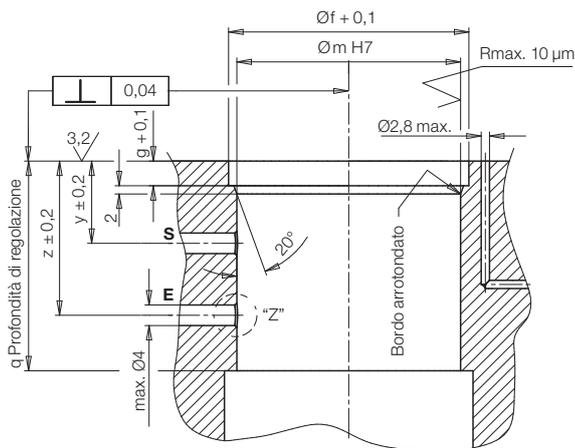
Foro per controllo pneumatico dell'appoggio
