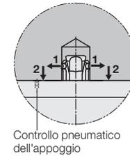
1 Espansione della bussola di bloccaggio con la forza della molla
