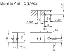
Esempio 1: Staffa a leva snodata 1825-011 Pressione d'esercizio 220 bar Leva di bloccaggio standard L = 22 mm
