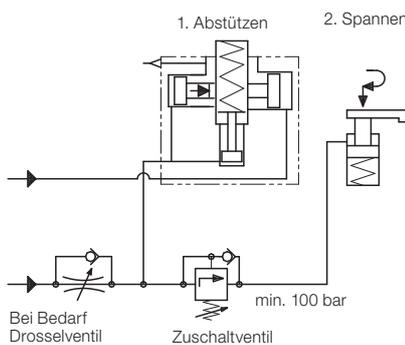
Das Zuschaltventil muss auf einen Öffnungsdruck oberhalb des Schnittpunkts der beiden Geraden im Diagramm eingestellt werden. Ist wegen zu hohem Volumenstrom ein Drosselventil erforderlich, sollte der Einbau wie im Hydraulikplan dargestellt erfolgen.
