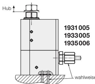
Bei Druckbeaufschlagung fährt der Stützbolzen aus und legt sich mit Federkraft an das Werkstück an. Danach erfolgt automatisch die Klemmung
