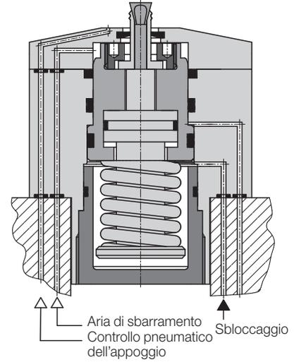
**Bussola di bloccaggio solo espansione**
