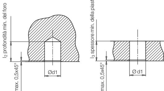
**Ø di regolazione della bussola di bloccaggio:  $k = d1 - 0,2 \text{ mm}$**
