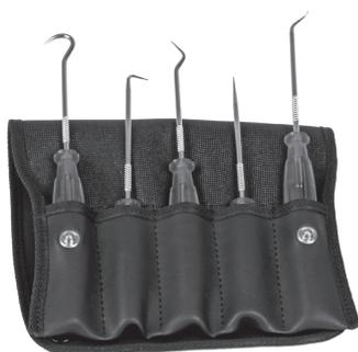
Serie estrattori per lo smontaggio di guarnizioni, contiene 5 attrezzi speciali in una busta. Con questi vari utensili modellati a forma di gancio, le guarnizioni possono essere rimosse dalle cave. Gli utensili sono arrotondati in modo speciale nella parte anteriore, per non danneggiare le guarnizioni.
