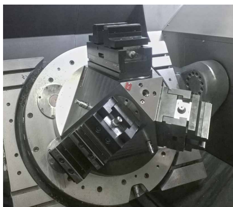
3 sistemi di bloccaggio dei pezzi MC-P in 3x 120° - Disposizione su un centro di lavoro a 5 assi.
