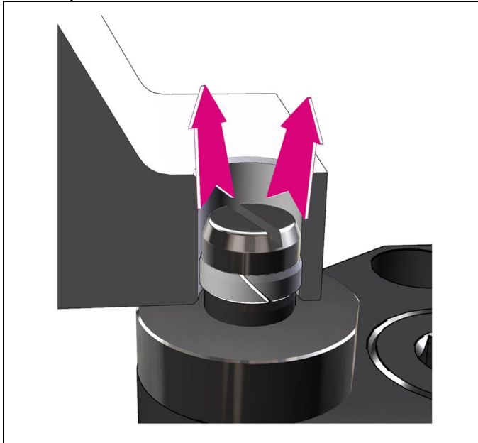
Abb. 3: Sperrluft bei aufgesetztem Werkstück (Im Halbschnitt)
