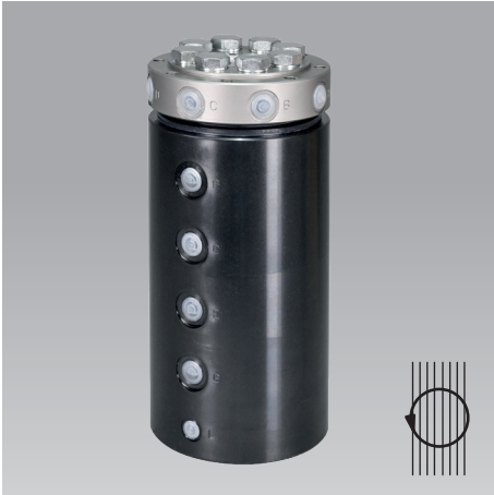
Achtadrigere Drehdurchführung mit Leckölrückführung im Gehäuse
