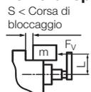
La staffa rotante ad azionamento elettrico può spostare, cioè posizionare, un pezzo contro punti fissi ancora prima della creazione della piena forza di bloccaggio.
