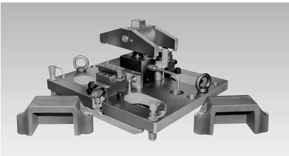
Die nebenstehende Abbildung zeigt eine hydraulisch betätigte Vorrichtung zum zentrischen Positionieren und Spannen von zwei gegossenen Gehäusen, bei denen die Innenflächen aus Funktionsgründen genau mittig zu den zu bearbeitenden Bohrungen liegen. Durch den Einsatz von Zentrisch-Spannelementen konnte die Bearbeitung der Innenflächen vermieden werden.
