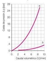
$a = eléctroválvula P \rightarrow A y A \rightarrow R$ b = válvula antirretorno insertable
