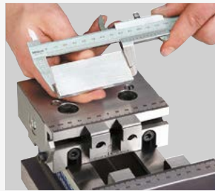
1. Rohling liegt ca. 2mm über dem Fertigmaß.
