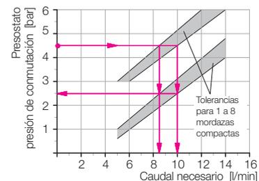
Caudal necesario en función de la presión de conexión del presostato neumático para una caída de presión  $\Delta p$  2 bar
