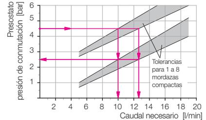
Caudal necesario en función de la presión de conexión del presostato neumático para una caída de presión  $\Delta p$  2 bar
