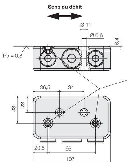
Pour le montage à flasquer enlever les vis cylindriques et les joints d'étanchéité. Monter les deux vis de fermeture G1/4 (référence 3300821). (Non inclus dans la livraison). Les deux joint toriques 10x2 (référence 3000347) ne sont pas inclus à la livraison.
