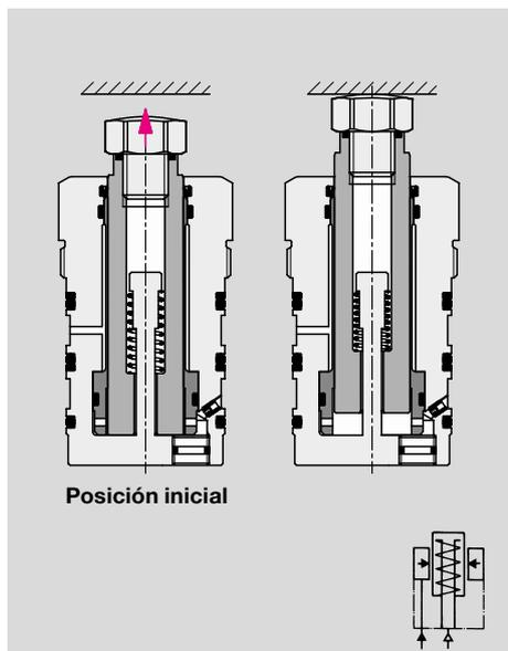
El bulón de apoyo se acerca a la pieza por la presión neumática. La fuerza de acercamiento es proporcional a la presión neumática menos la fuerza de retroceso por muelle
