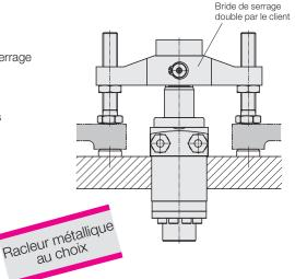
Vérin de serrage pivotant avec contrôle de position au choix (accessoire)
