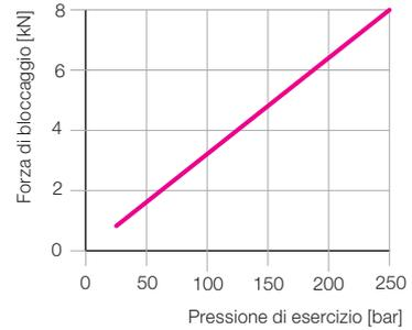
**Bloccaggio e sbloccaggio**
