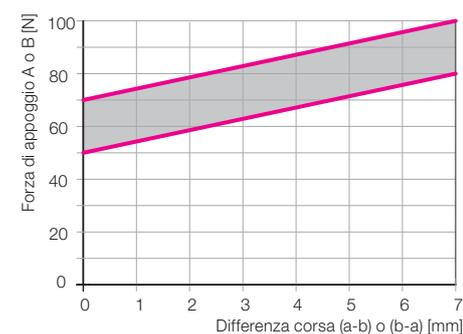
Diagramma valido per posizione di montaggio orizzontale.
