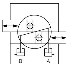
Posición de las correderas de sujeción para la sujeción interior y exterior ver página 2
