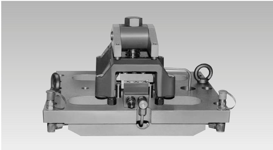
La figura de lado muestra un útil de accionamiento hidráulico para el posicionado y la sujeción autocentrante de dos cuerpos fundidos en los cuales las superficies interiores están por razones del funcionamiento exactamente concéntricas referente a los orificios a mecanizar.
