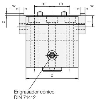
Fijación u: 3 tornillos allen con exágono interior DIN 912/10.9
