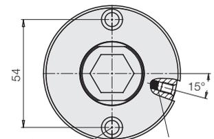
Bohrung und Senkung Ø 7 / Ø 10,5 x 7 tief für Zyl.-schraube ISO4762 M 6 x 85
