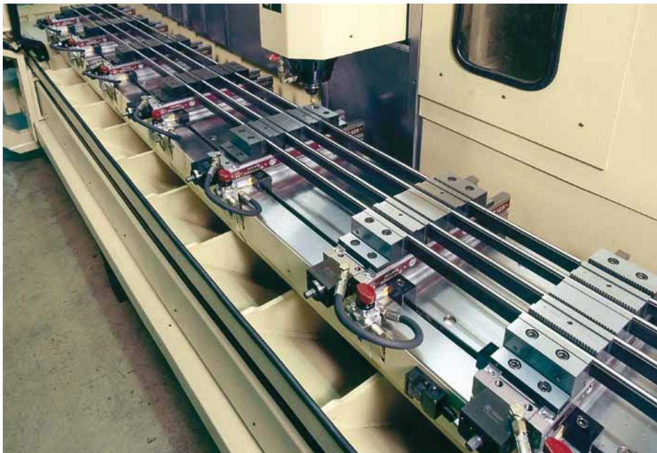
DS ad azionamento idraulico, Impiego in disposizione su file per il bloccaggio di pezzi che richiedono più punti di serraggio. Possibilità di automazione.
