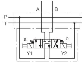
Electroválvula 4/3 con placa de montaje para circulación sin presión en posición media. Orificios A y B cerrados, con fugas.
