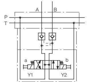
Electroválvula 4/3 con placa de montaje para circulación sin presión en posición media. Orificios A y B cerrados por válvula antirretorno doble y sin fugas.
