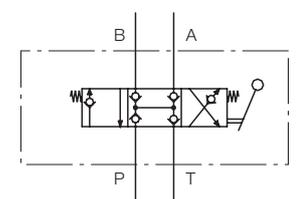
Electroválvula 4/3 con posición central cerrada sin fugas. Accionamiento por palanca con retroceso por muelle hasta presión de servicio de 300 bar. En el caso de presiones más altas no retroceso automático de la palanca. Utilizando esta válvula, la central debe trabajar en funcionamiento intermitente, o se debe accionarla con una válvula para circulación sin presión.
