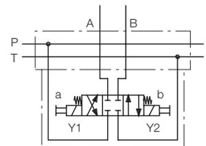
Electroválvula 4/3, orificios A y B cerrados, con fugas.
