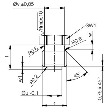
**Orificio roscado para montaje**
