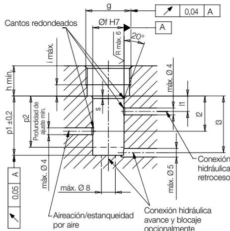
**Dimensiones para tornillos de presión fabricados por el cliente**
